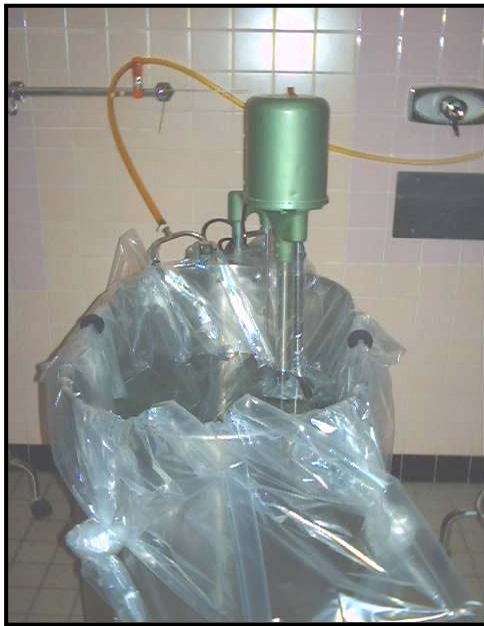
Membrane de plastique jetable dont les deux tuyaux sont reliés à une prise d'air murale
